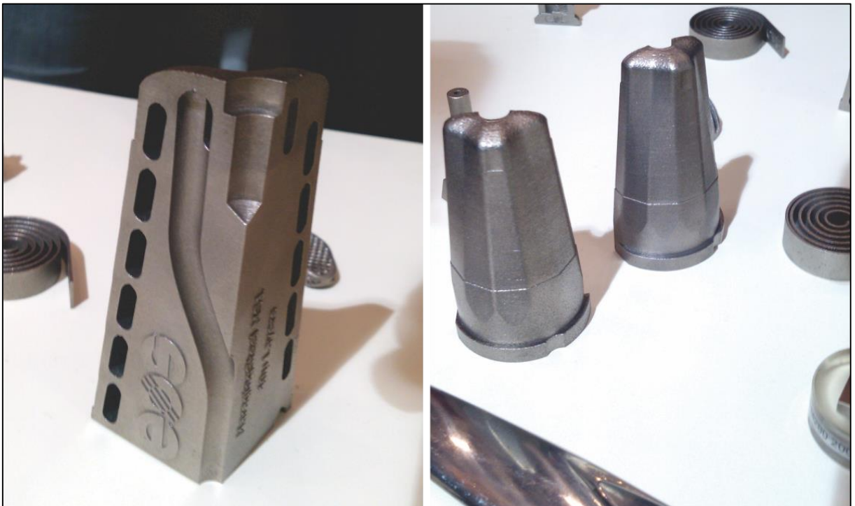
Figura 26 - Postiço para refrigeração de Molde plástico
