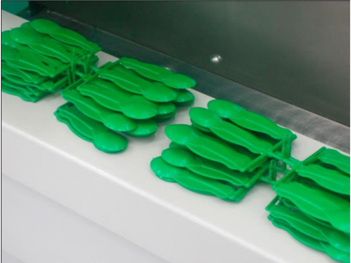
Figura 23 - Produto acabado manufaturados nos Moldes criados na impressora Stratasys
