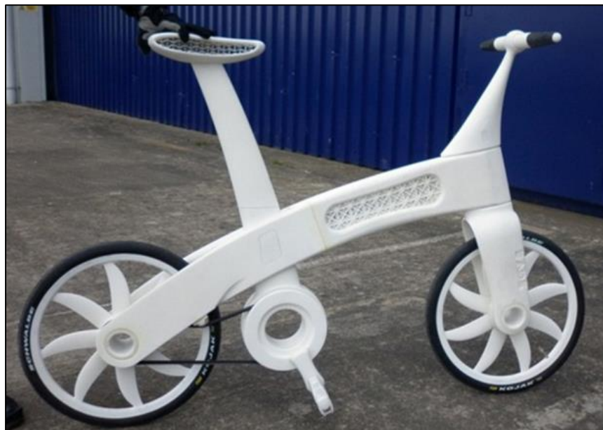
Figura 12 - Bicicleta feita de nylon endurecido tão resistente quanto metal
