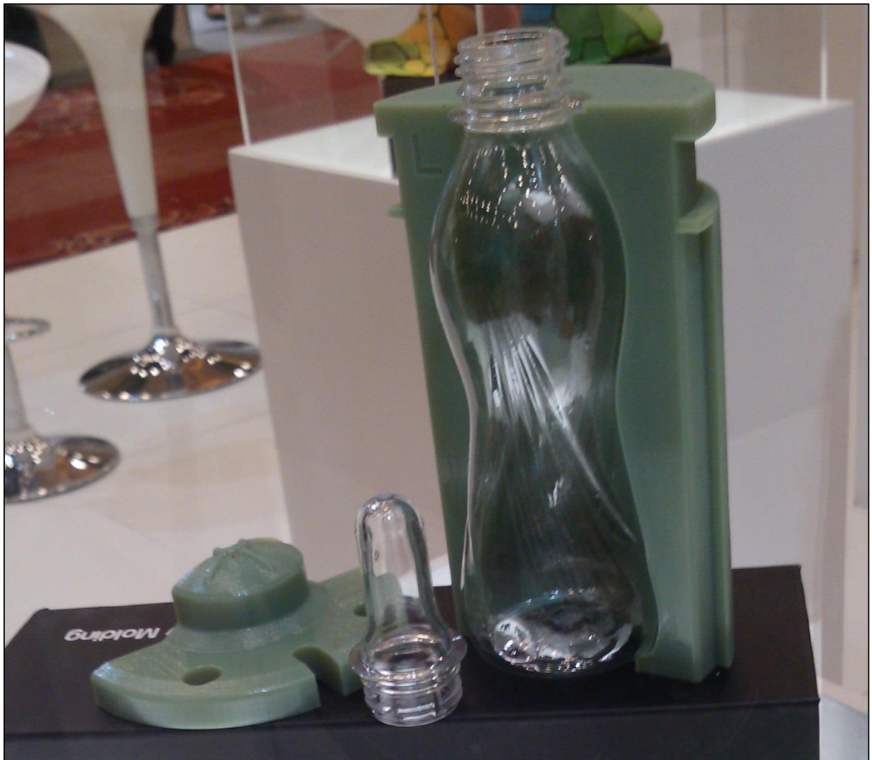
Figura 24 - Molde de Sopro Manufaturado em impressora 3D
