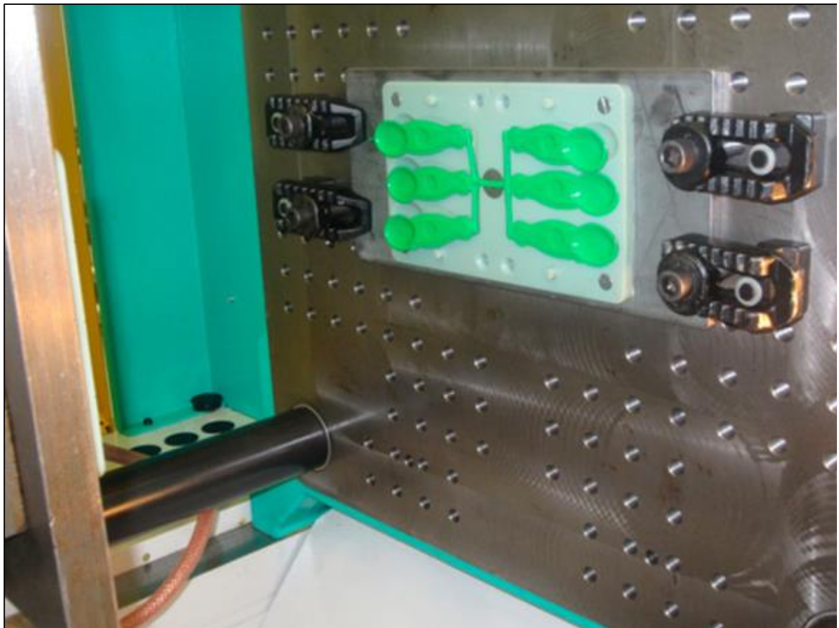
Figura 22 - - Moldes gerados na impressora 3 D
